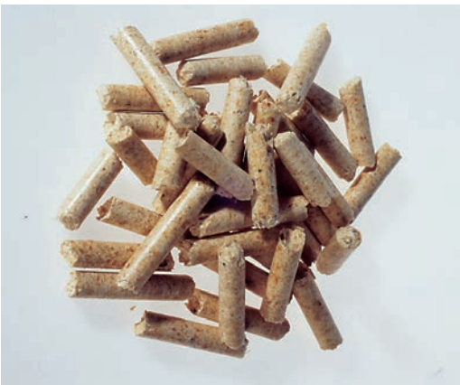
Holzpellets sind kleine Holzpresslinge, die einem Brenner automatisch zugeführt werden können.
