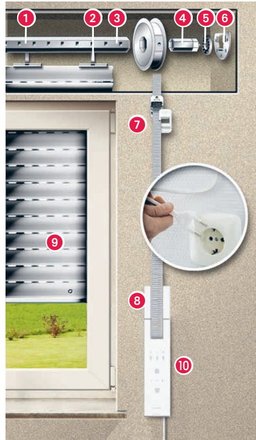
1 Achtkantwelle 2 Rollladenaufhängung 3 Rollladengurtscheibe 4 Walzenhülse 5 Kugellager 6 Lagerschale 7 Rollladengurtführung 8 Rollladengurt 9 Rollladenpanzer 10 Rollladengurtantrieb
