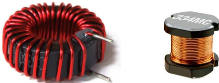
Abbildung 29: Ringkern (Toroid) Spule mit Eisenkern (links); Spule (rechts)
