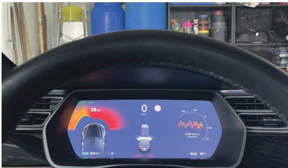
Die Objekterkennung des Tesla S 90D hält ein Regal in einer Garage für einen Lkw (graues Symbol in der Mitte des Fahrzeug-Displays).
