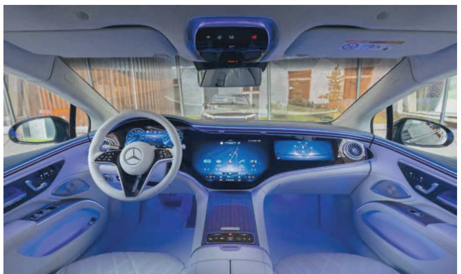
Im EQS kann man den Hyperscreen konfigurieren, der sich hinter einer Glasplatte von A-Säule zu A-Säule erstreckt (Pillar-2-Pillar-Design).
