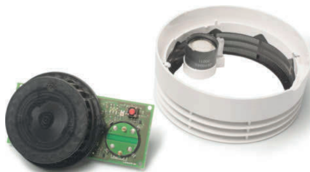
In der Messkammer optischer Rauchmelder messen Fotodioden die Partikeldichte der Luft.
