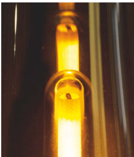
Das Filament-Leuchtmittel des MoriMori ist in einem zusätzlichen Diffusor verpackt und sorgt für den Glüh-Effekt.
