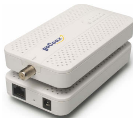
Die MoCA-Adapter goCoax MA2500D schleusten im c't-Labor schon 2,3 Gbit/s auf Anwendungsebene durchs Koax.
