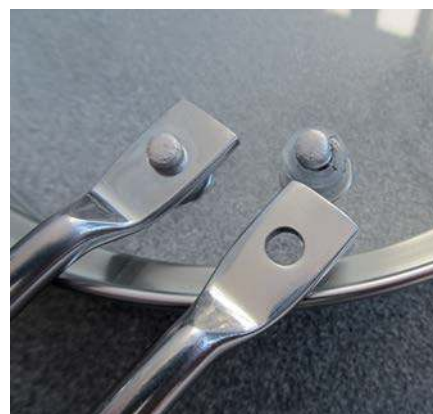
Im Geschirrspüler. Die Niete eines Tchibo-Deckels korrodierte und löste sich.
