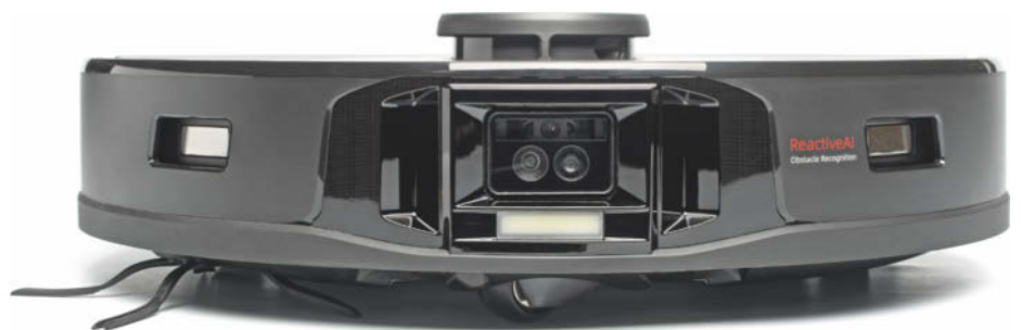
Der Lidar-Turm dient der groben Orientierung. Dank Kameras und IR-Sensoren erkennt der S7 MaxV auch kleine Hindernisse, über die andere Bots stumpf rüberfahren.
