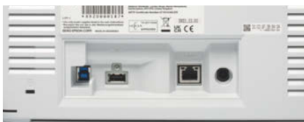
Der Epson DS-790WN besitzt auf der Rückseite außer der obligatorischen USB-Schnittstelle Gigabit-Ethernet und einen USB-Host-Port zum direkten Scannen auf einen Speicherstick.
