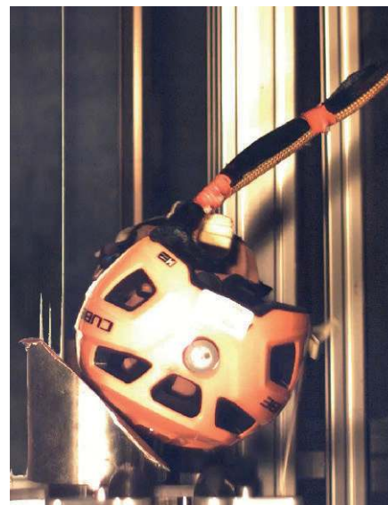
Nah an der Wirklichkeit. Der Helm saust auf eine geneigte Ebene. Dies stellt ein realistisches Sturzzenario nach.
