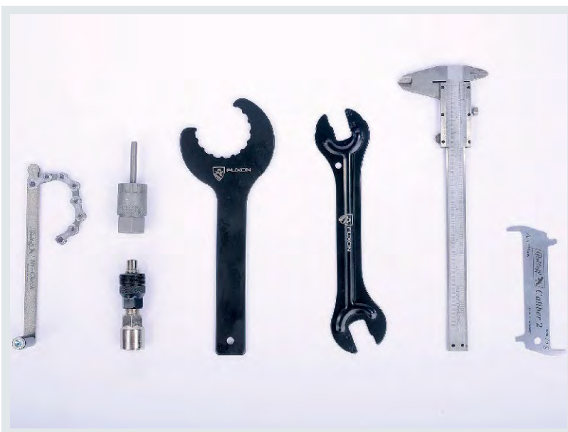
SPEZIALWERKZEUGE von links nach rechts: Verschleißlehre für Zahnkränze, Kurbel- und Kranzabzieher, Tretlagerwerkzeug (Hollowtech), Konusschlüssel, Messlehre, Kettenverschleißlehre
