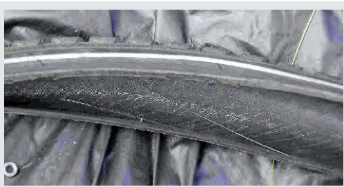
Drahtbruch beim Reifen
