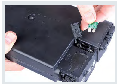
Schmelzsicherung des Akkupacks
