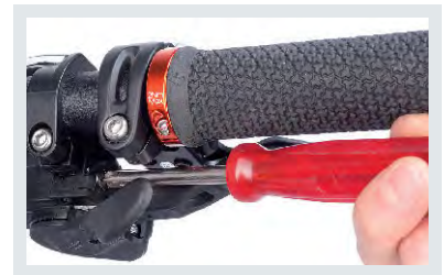
Bei der Shimano Rapid-Fire muss eine Kunststoffschraube gelöst werden, bevor man an die Enden der Schaltseile herankommt.
