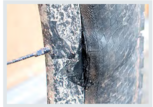
Seitenflanke des Reifens aufgerissen
