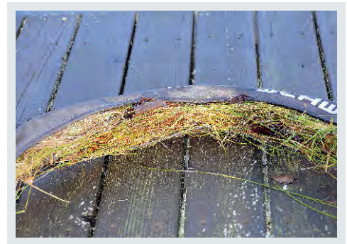
Schlauchersatz: Reifen ausstopfen
