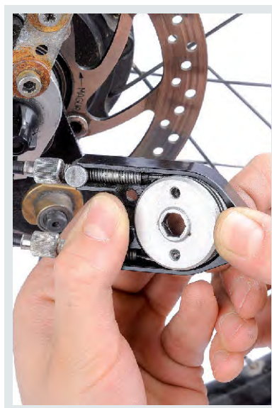
Die Seiltrommelinnenseite muss bei Rohloff Speedhub 500/14 bei Bedarf überprüft und gereinigt werden.
