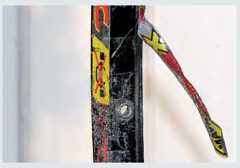
Felge eingerissen. Gewebeklebeband stabilisiert.
