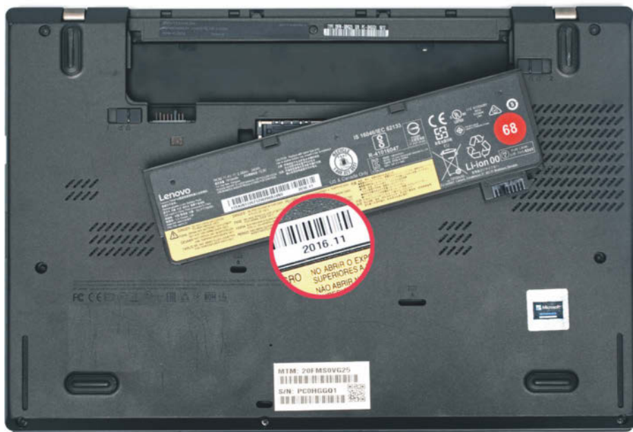
Das gebrauchte ThinkPad T460 hat einen wechselbaren Akku, doch der ist genauso alt wie das Notebook selbst: Er wurde im November 2016 gefertigt.
