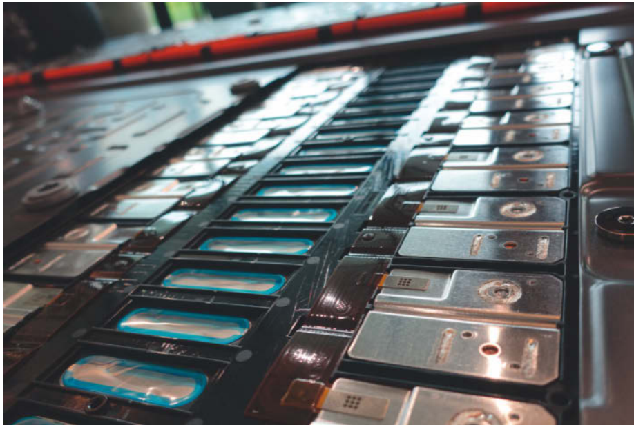
Die einzelnen Zellen sind in den Fahrzeugakkus zu Clustern zusammengelegt.
