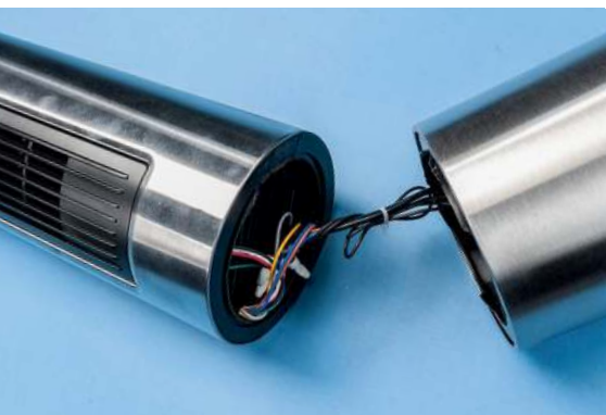
Nicht stabil. Der Profi Care brach im Kipptest immer an der gleichen Stelle.
