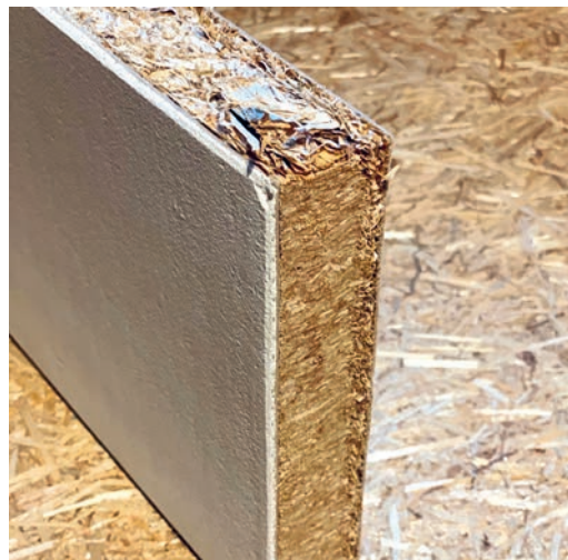
Strohbauplatten werden mit L-Profilen an Decke und Boden befestigt und bieten einen guten Schallschutz.
