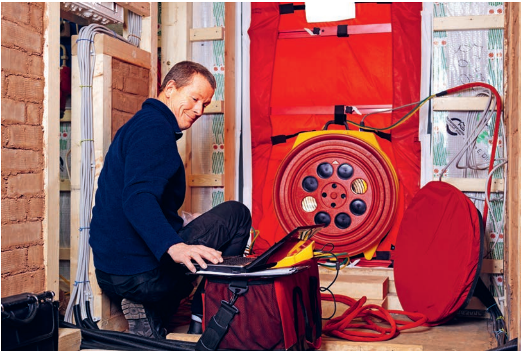
Messen der Luftdichtheit mittels Blower-Door-Test: Über einen Ventilator wird im Haus Unterdruck erzeugt.
