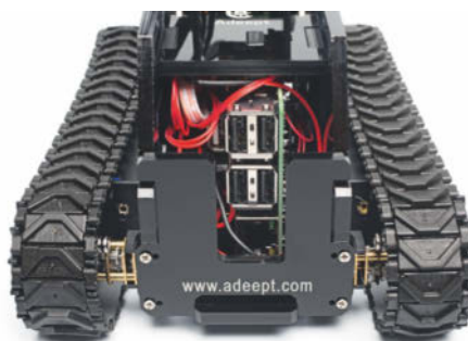
Beim zusammengebauten RaspTank bleiben von hinten die USB-Ports des verbauten Raspis und von unten (rechts) die Micro-USB- und HDMI-Buchse zugänglich.
