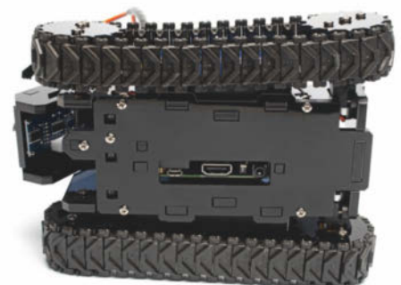
Beim zusammengebauten RaspTank bleiben von hinten die USB-Ports des verbauten Raspis und von unten (rechts) die Micro-USB- und HDMI-Buchse zugänglich.
