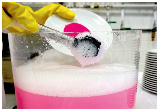
Ergiebigkeitstest. Die Testerin bürstet Teller ab, bis der Schaum zusammenbricht und dauerhaft aufreißt. Der pinke Farbstoff macht den Prüfschmutz sichtbar.
