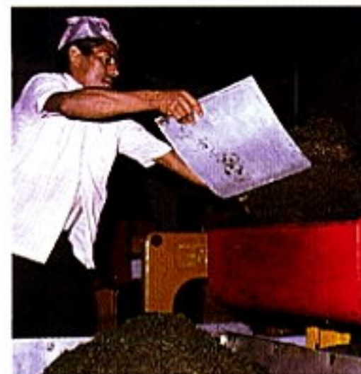
Rüttelsiebe trennen den Tee nach Größe.
