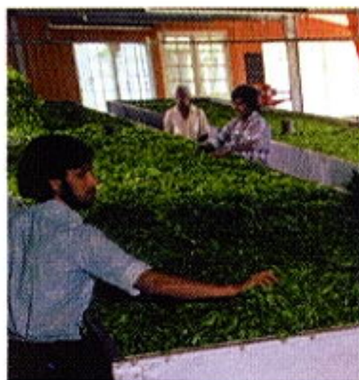
Teeblätter liegen zum Welken in speziellen Welktrögen in einer Teefabrik in Sri Lanka.
