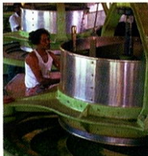
Bereits in dieser Rollmaschine beginnen die Teeblätter zu fermentieren.
