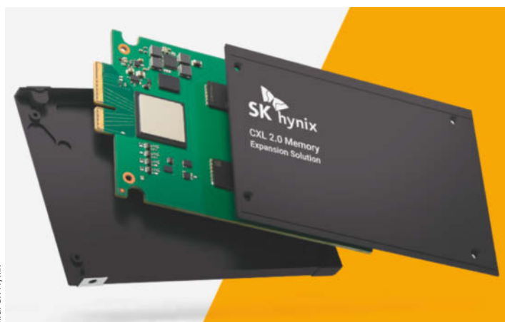
SK Hynix nutzt CXL 2.0, um bis zu 96 GByte DDR5-RAM flexibel an CPUs anzubinden.
