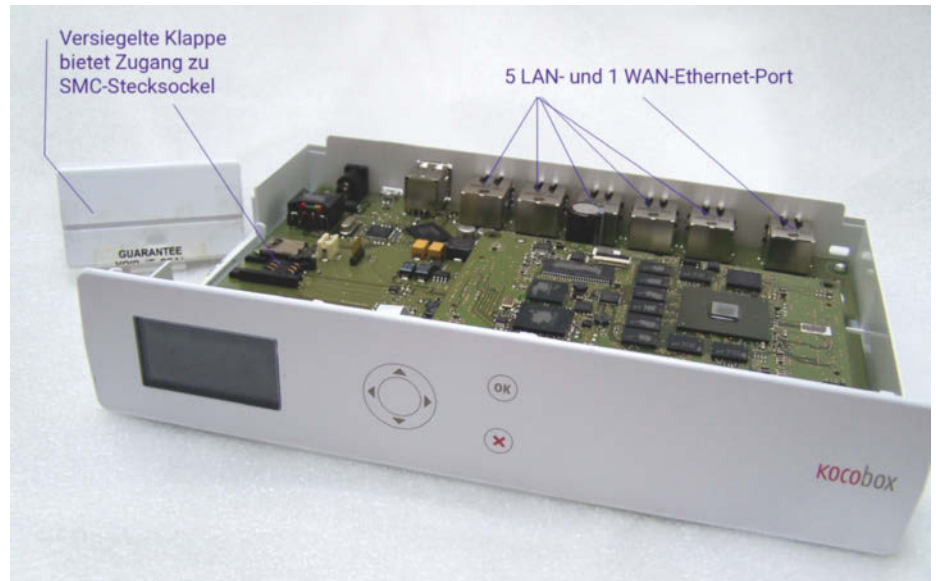
Diese frühe Version der KoCoBox erlaubte einen Austausch der gSMC-K-Karte über eine Gehäuseklappe. Das Modell war in hunderten Arztpraxen produktiv im Einsatz – zumindest in einer bis Mai 2018.
