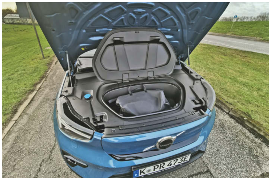
Aufgrund der kompakten E-Motoren bleibt unter der Haube meist Platz für zusätzlichen Stauraum. Viele Hersteller nutzen ihn für die Ladekabel.
