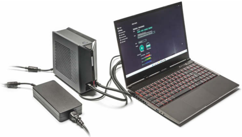
Schenker bietet für das XMG15 eine externe Flüssigkühlung an (Bildmitte). Viel Performance bringt der Extra-Klotz leider nicht.
