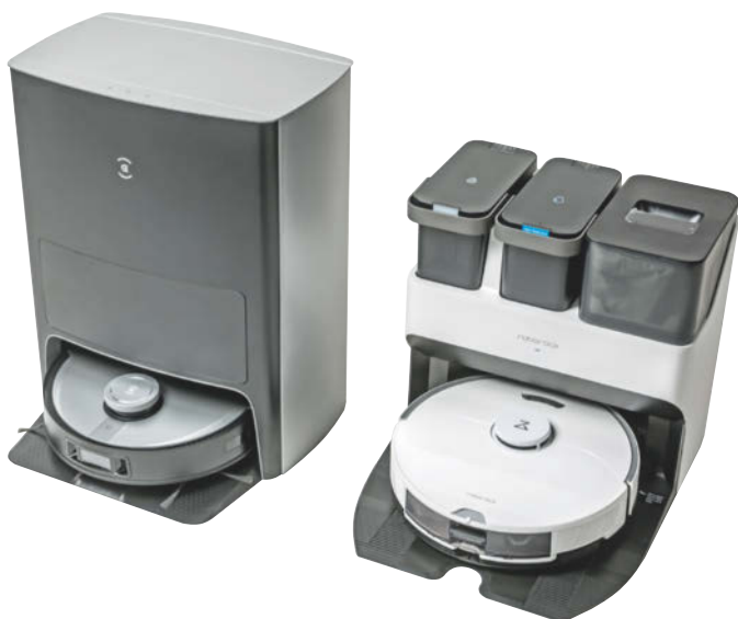
Die Absaugstationen von Ecovacs (links) und Roborock reinigen auch die Wischmopps der Bots. Dafür haben sie Tanks für Frisch- und Schmutzwasser.
