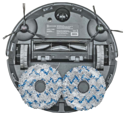
Der Ecovacs-Bot hat keinen klassischen Wischmopp, sondern zwei gegenläufig rotierende Wischtücher.
