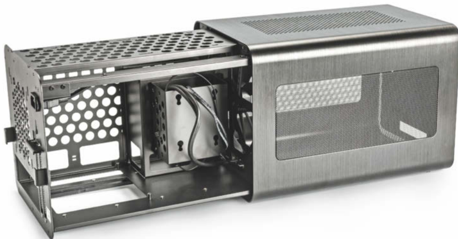
Einfach eingeschoben: Beim Silverstone Sugo 15 sitzt das Innenleben auf einem herausziehbaren Schlitten.
