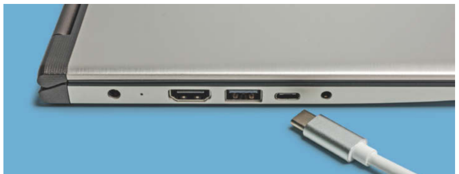
USB-C und Thunderbolt können sämtliche andere Buchsen dieses Notebooks ersetzen: USB-A, HDMI, Audio und Stromanschluss.
