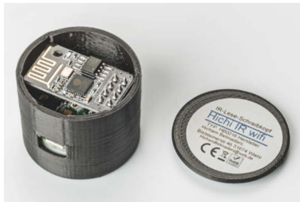
Der rund 35 Euro teure Hichi-WLAN-Lesekopf besteht aus einem ESP8266 mit der Open-Source-Firmware Tasmota und einer Adapterplatine für Infrarot. Er wird magnetisch auf die bei vielen Zählern vorhandene Info-Schnittstelle gesetzt und per Micro-USB mit Spannung versorgt.
