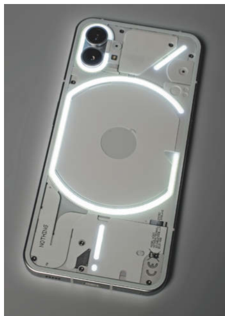
900 LEDs in fünf Elementen bilden die sogenannte Glyphie. Nach einiger Zeit haben wir die Blinklichter aber ausgeschaltet.
