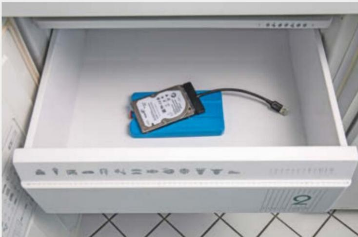
tige Medien sprichwörtlich auf Eis zu legen und sie im Tiefkühler per USB-Adapter auszulesen, indem man das USB-Kabel durch die Dichtung nach außen zum Rechner führt. Zur besseren Wärmeableitung sollte man außerdem das Plastikgehäuse von USB-Sticks und -Kartenlesern entfernen.
