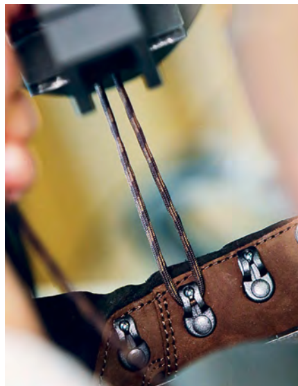
Haltbarkeit der Haken. Im Test wird gezogen, bis es reißt.
