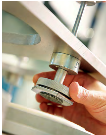
Abriebfestigkeit des Futters. Die Stoffe werden im Test auf Stempel gespannt und gegen ein Prüfgewebe gerieben.
