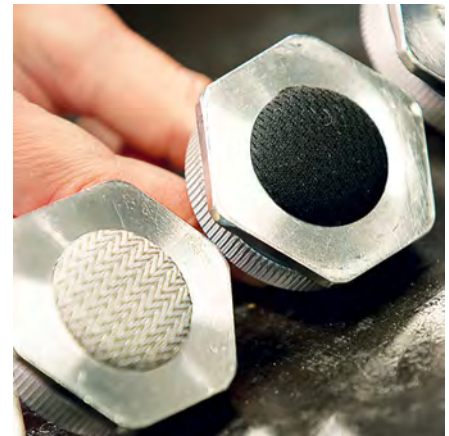
Abriebfestigkeit des Futters. Die Stoffe werden im Test auf Stempel gespannt und gegen ein Prüfgewebe gerieben.
