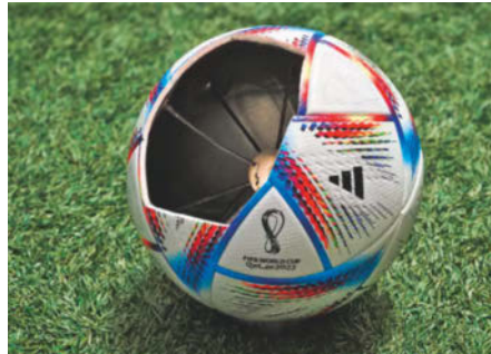
Die Bewegungssensoren sind so im WM-Fußball AI Rihla aufgehängt, dass sie das Flugverhalten des Balls nicht beeinflussen.
