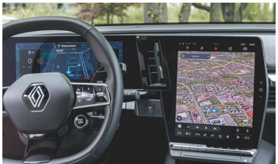
Google Maps auf dem Tachodisplay (Android Automotive) und Google Maps in der Mittelkonsole (Android Auto) arbeiten im Megane E-Tech Hand in Hand. Die Satellitendarstellung gibt es nur übers Smartphone, die präzise Routen- und Ladeplanung übers Bordsystem.
