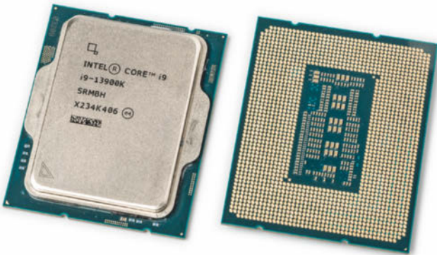
Die 1700 Kontaktflächen auf der Unterseite des Prozessor-Packages dienen zur Spannungsversorgung sowie für PCI-Express- und Speicherdatenleitungen. Damit sind die Core-i-13000 kompatibel zu Mainboards mit Serie-600- und -700-Chipsätzen.
