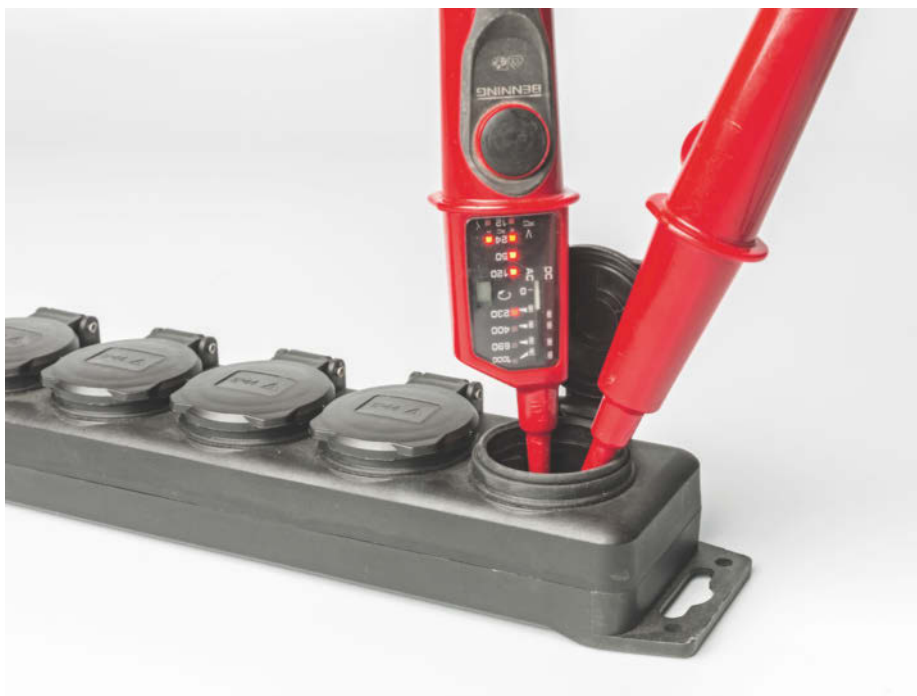
Die Spannungsfreiheit muss man mit einem zweipoligen Spannungsprüfer feststellen. Der Markenname DUSPOL ist zum Gattungsbegriff für solche Messgeräte geworden.
