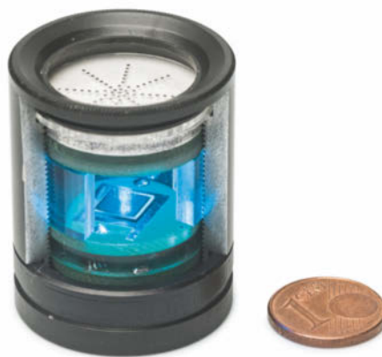
Der neue Geruchssensor hat etwa Form und Größe eines Filmdöschens. Unter der aufgeschnittenen Messkammer ist der Emitterschip zu sehen, der Elektronen mit einer Energie zwischen 5 und 17 Elektronenvolt abstrahlt.
