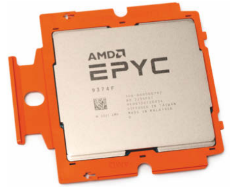
Der AMD Epyc 9004 Genoa passt in die neue Prozessorfassung SP5, die 6096 Kontaktfedern hat, um zwölf RAM-Kanäle und 128 PCIe-Lanes anzubinden.
