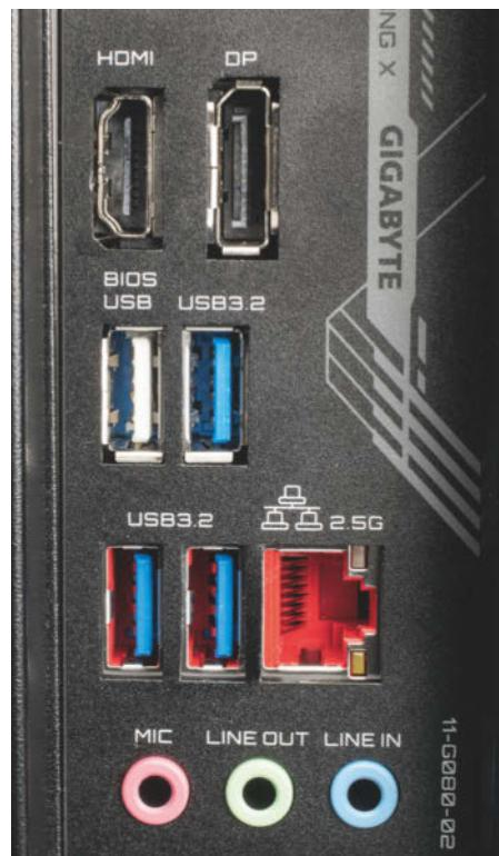
Über den weißen USB-Port lässt sich das BIOS des Gigabyte B660M Gaming X AX DDR4 per Flashback auch ohne CPU aktualisieren.
