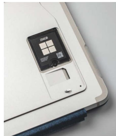
**Die SSD ist wechselbar; statt Schrauben halten Magnete die Abdeckung für M.2-Schacht und SIM-Kartenleser (nur SQ3-Modell) in Position.**
