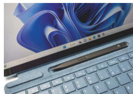
**Der Slim Pen 2 verschwindet in einer Aussparung der Tastaturhülle und wird dort auch für den nächsten Einsatz geladen.**
