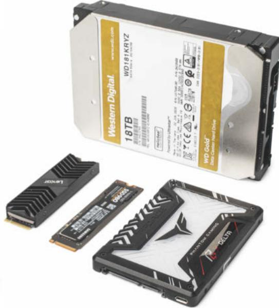
Bei Massenspeichern setzen sich die kleinen M.2-SSD-Kärtchen durch. Gängig sind bereits 2 TByte Kapazität und Transferraten von über 3 GByte/s. Kühlkörper (ganz links) sind mehr Zierrat, als dass sie die Leistung außerhalb synthetischer Benchmarks wirklich verbessern.
