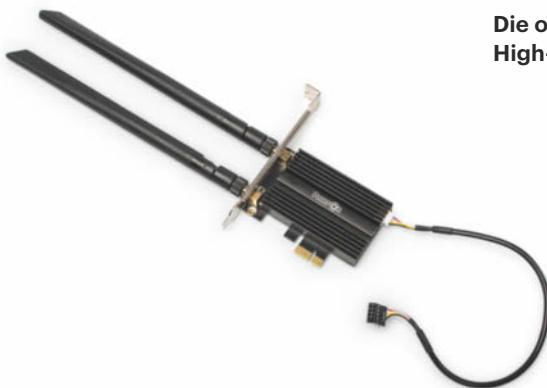
Die optionale WLAN-Karte bindet den High-End-PC in Drahtlosnetzwerke ein.
