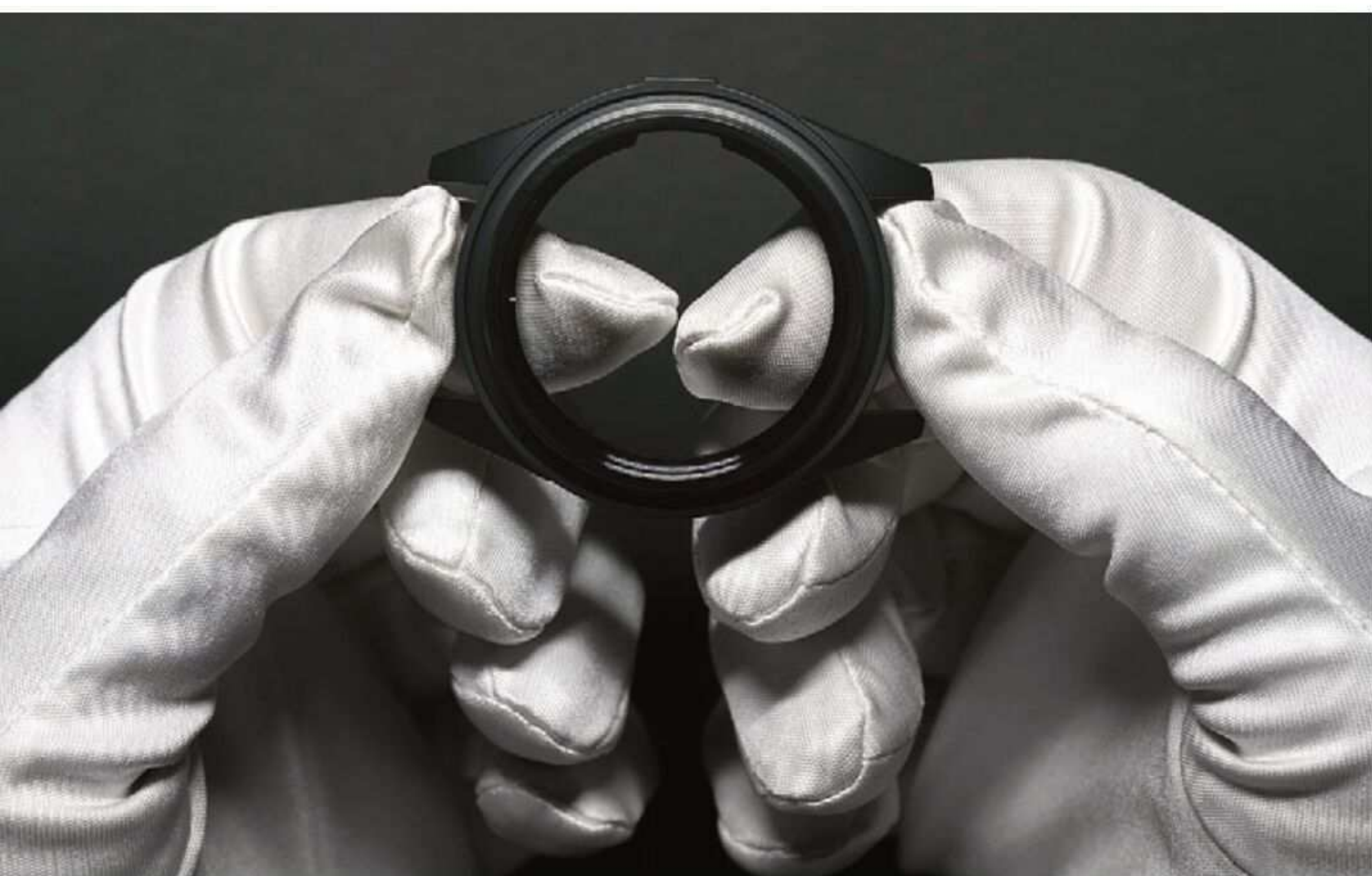
Bei der Kontrolle muss das Gehäuse aus Hightech-Keramik perfekt sein, um in die Montage zu kommen
