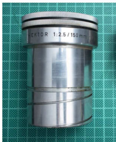
Das Leitz Hektor mit 150 Millimeter Brennweite und einer festen Blende von f/2.5.
