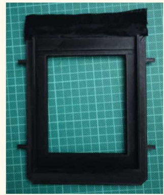
Das 3D-gedruckte Rückteil für die Planfilmkassetten.
