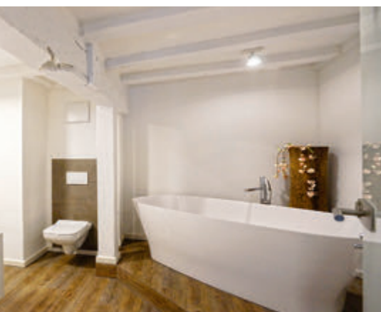
In den Bädern des Stadthauses Monschau puffert Lehmputz Feuchtigkeitsspitzen in der Raumluft sehr gut ab. Die "Kölner Decken" sind eine Besonderheit der Region.
