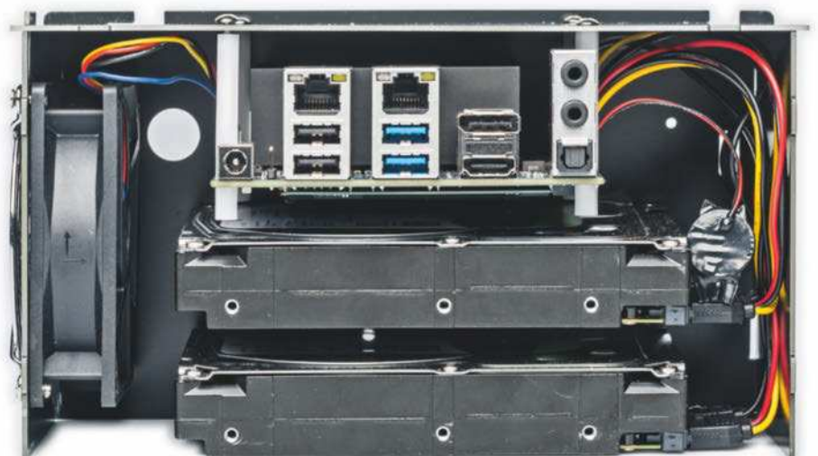
Das entfernte Seitenteil gibt den Blick frei auf Odroid-Platine, den Lüfter, zwei 3,5-Zoll-Platten und SATA-Daten und -Stromkabel.
