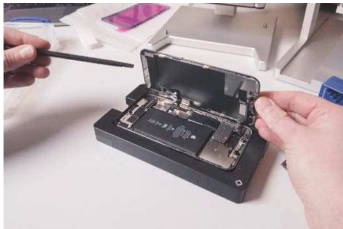
Das iPhone-Display klappt man zur Seite weg, um die Kabel von der Hauptplatine zu lösen.
