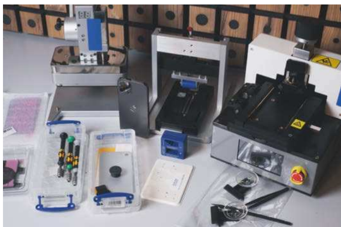
Zwei schwere Werkzeugkoffer und drei große Maschinen gehören zum Werkzeugkit für den Akkutauch des iPhone 12 Pro.
