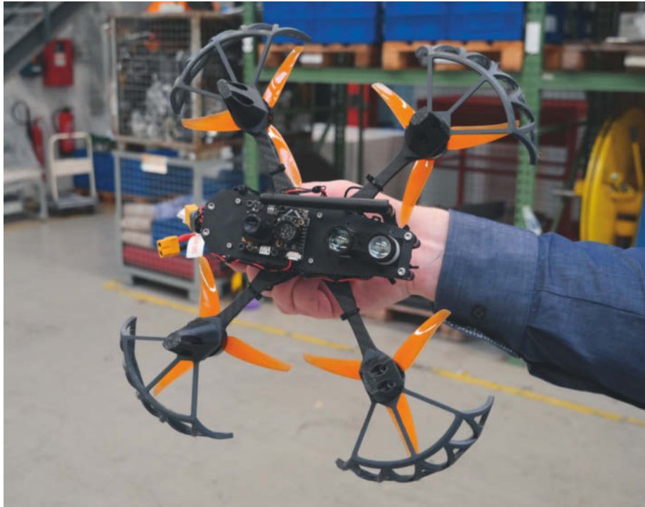
An der Unterseite ist die Drohne mit einem Optical-Flow-Modul (links) und einem Abstandssensor (rechts) ausgestattet. Damit orientiert sie sich beim Kartieren einer Halle.
