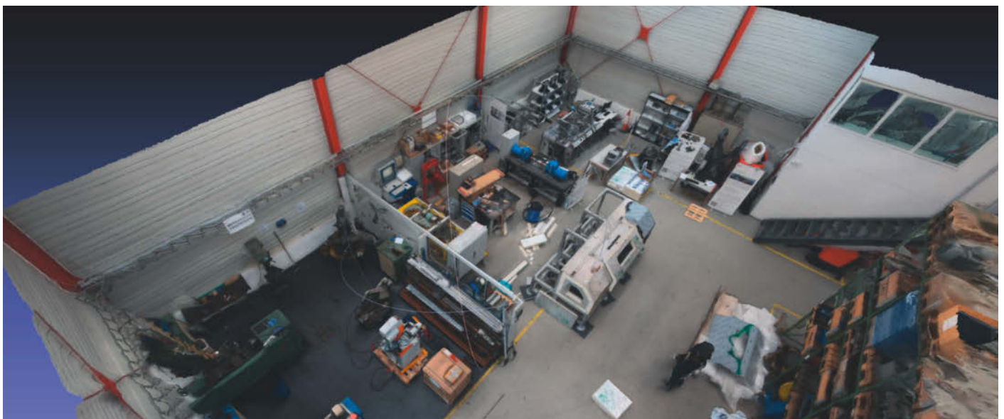
Aus Hunderten von Einzelaufnahmen der autonomen Drohne ist ein komplettes Hallenlayout für die Fabrikplanung entstanden.
