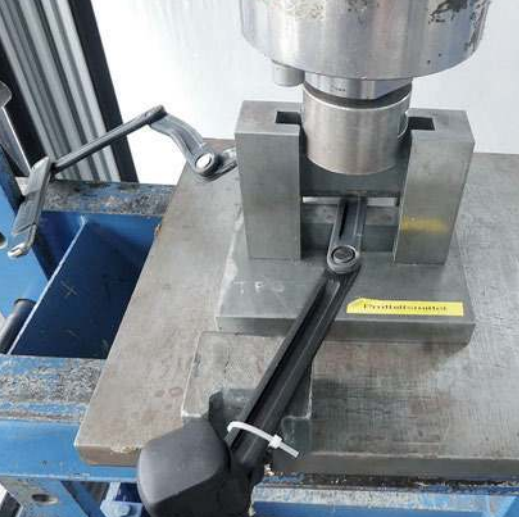
Mini-Guillotine im Prüflabor. Das Faltschloss Abus Bordo Lite leistete der Klinge kaum Widerstand.
