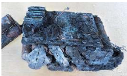
Verkohlt. Vom getesteten Primaster-Akku ist nach dem Feuer wenig übrig.
