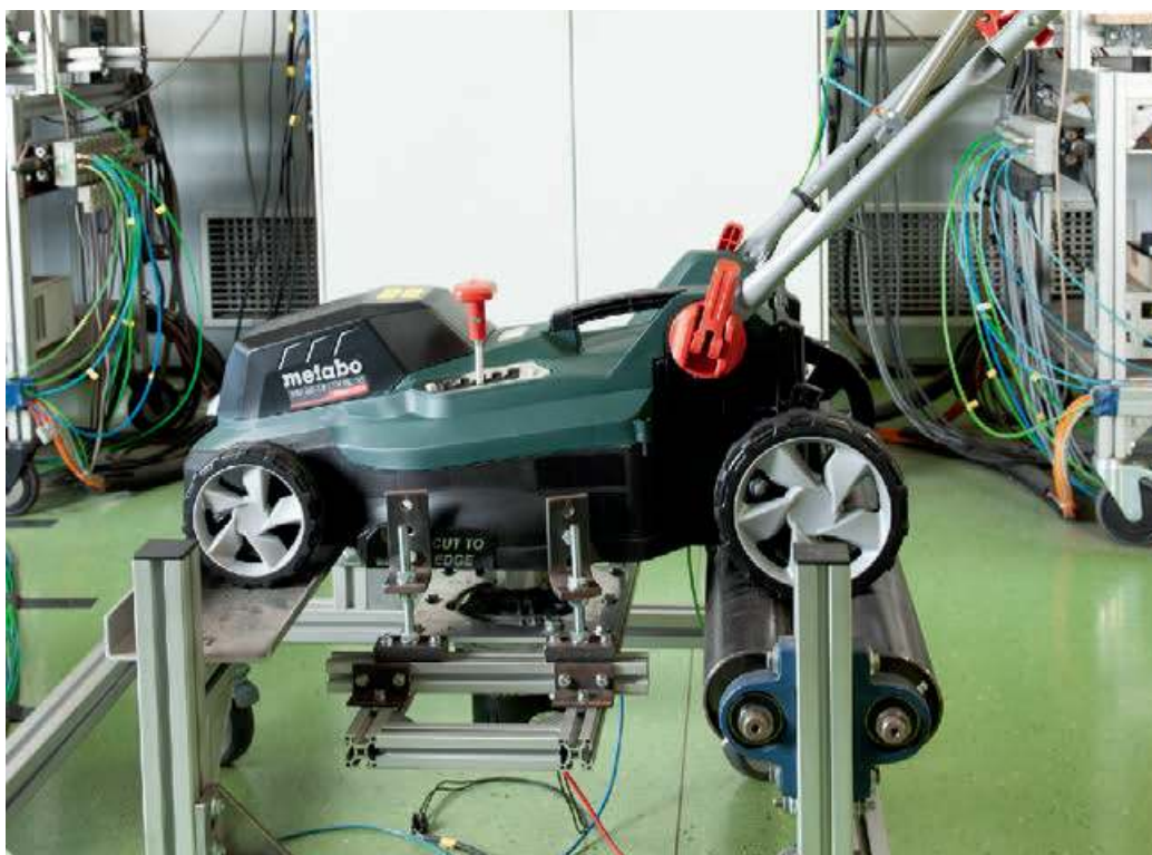
Vor dem Feuer. Auf diesem Prüfstand sollte jedes Gerät 300 Mal „mähen“. Der Primaster (nicht im Bild) geriet dabei in Brand.
