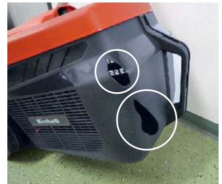
Steinschlag. Kugeln, die Steine simulieren, durchschossen den Einhell Rasarro.
