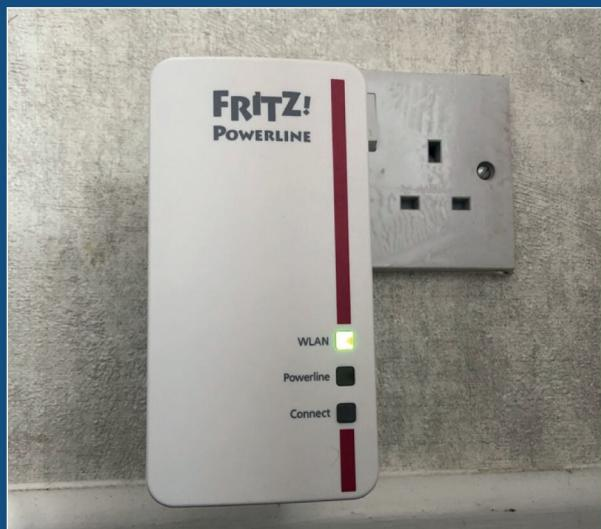
**12** Lesen Sie die Anleitung für die Powerline-Geräte. Der WLAN-Access-Point sollte an der Vorderseite ein WLAN-LED aufweisen. Als erstes stecken Sie das andere Powerline in eine Steckdose in der Nähe Ihres Routers. Verbinden Sie den Router mit einem Ethernet-(LAN)Kabel mit dem LAN-Anschluss an der Unterseite des Geräts.
