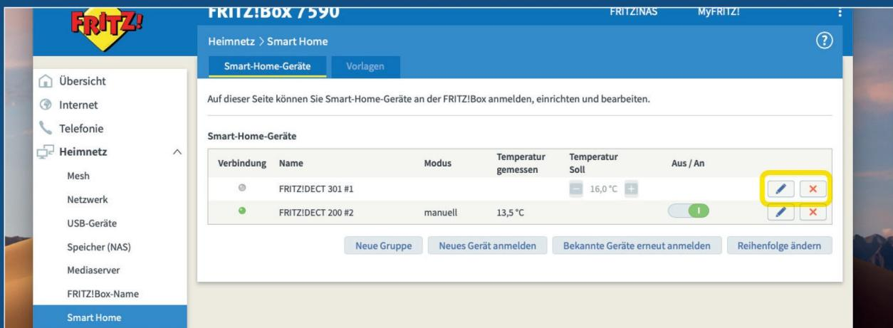
**5** Die unter „Heimnetz > Smart Home“ angezeigte Seite zeigt die mit Ihrem FRITZ!Box-Router verbundenen Smart-Home-Geräte. Hier melden Sie neue Geräte an, ändern deren Anzeigereihenfolge usw. Zum Ändern der Geräteeinstellung drücken Sie das Bleistiftsymbol. Möchten Sie ein Gerät aus der FRITZ!Box abmelden, drücken Sie auf das Kreuz.
