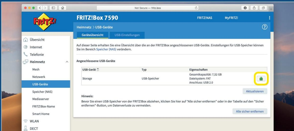
**3** Aktuelle Router besitzen einen oder zwei USB-Ports. Stecken Sie den USB-Stick, die USB-Festplatte oder das Kartenlesegerät in einen davon. Bei zwei USB-Ports können Sie beide verwenden. Sie müssen ihren Router vorher nicht ausschalten, aber vor dem späteren Entfernen des Geräts gehen Sie auf „Heimnetz > USB-Geräte“ und klicken zunächst auf „Entfernen“.
