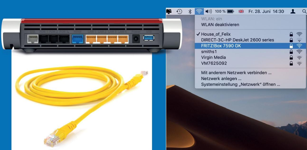
**1** Eine Kabelverbindung über Ethernet ist einfach. Mittels des Ethernet-Kabels (s. Foto) verbinden Sie Ihre FRITZ!Box (über eine der gelben Buchsen) mit der Ethernet-Buchse Ihres Computers oder Internet-Geräts. Diese Kabelverbindungen werden als LAN (Local Area Network) bezeichnet.
