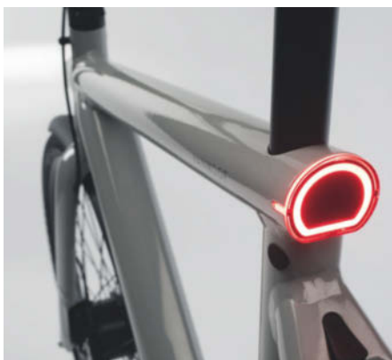
Die markanten Lichter im Oberrohr sind ein Erkennungszeichen der VanMoof-E-Bikes. Zwischen den Sitzstreben sitzt der Ladeanschluss.
