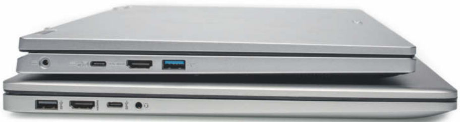
Die USB-C-Buchse von Acers Aspire 3 Spin 14 (oben) transferiert Daten mit 10 Gbit/s, gibt DisplayPort-Signale aus und nimmt Netzteile entgegen. Die USB-C-Buchse am HP 17 (unten) beherrscht hingegen ausschließlich 5-Gbit/s-USB.
