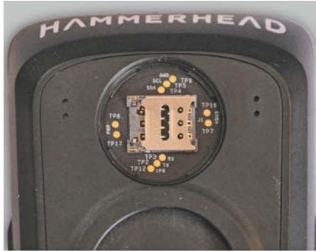
Der Hammerhead Karoo 2 hat unter einem Deckel eine Halterung für eine SIM-Karte für Mobilfunk.
