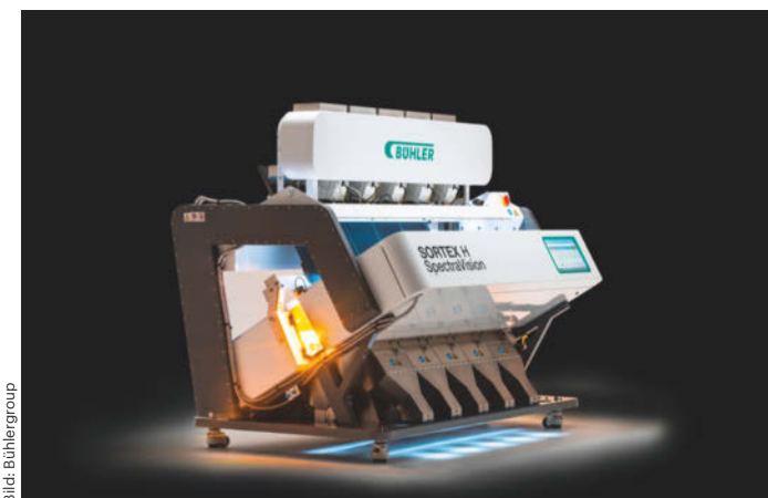
Die Sortiermaschine Sortex H von Bühler erkennt pilzbefallene Maiskörner ...
