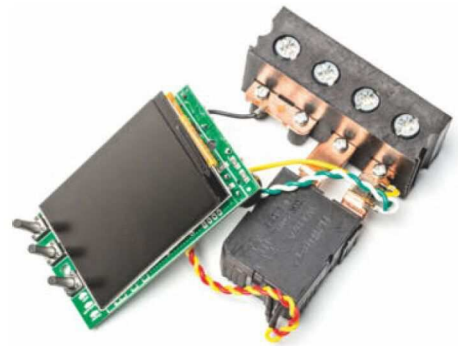
Im AT4PW von Atorch steckt ein Relais im Strompfad. Der Messwiderstand für den Strom liegt im Kupferstrang, der zum Relais führt.
