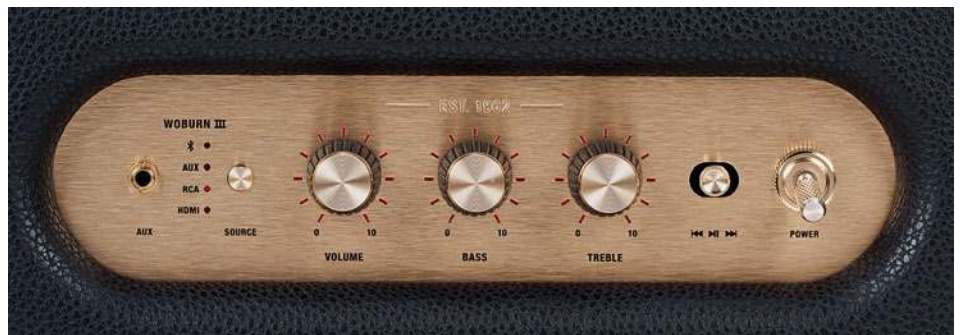
Knopfleiste. Die kabelgespeisten Marshalls haben Regler für Lautstärke, Bass und Höhen.
