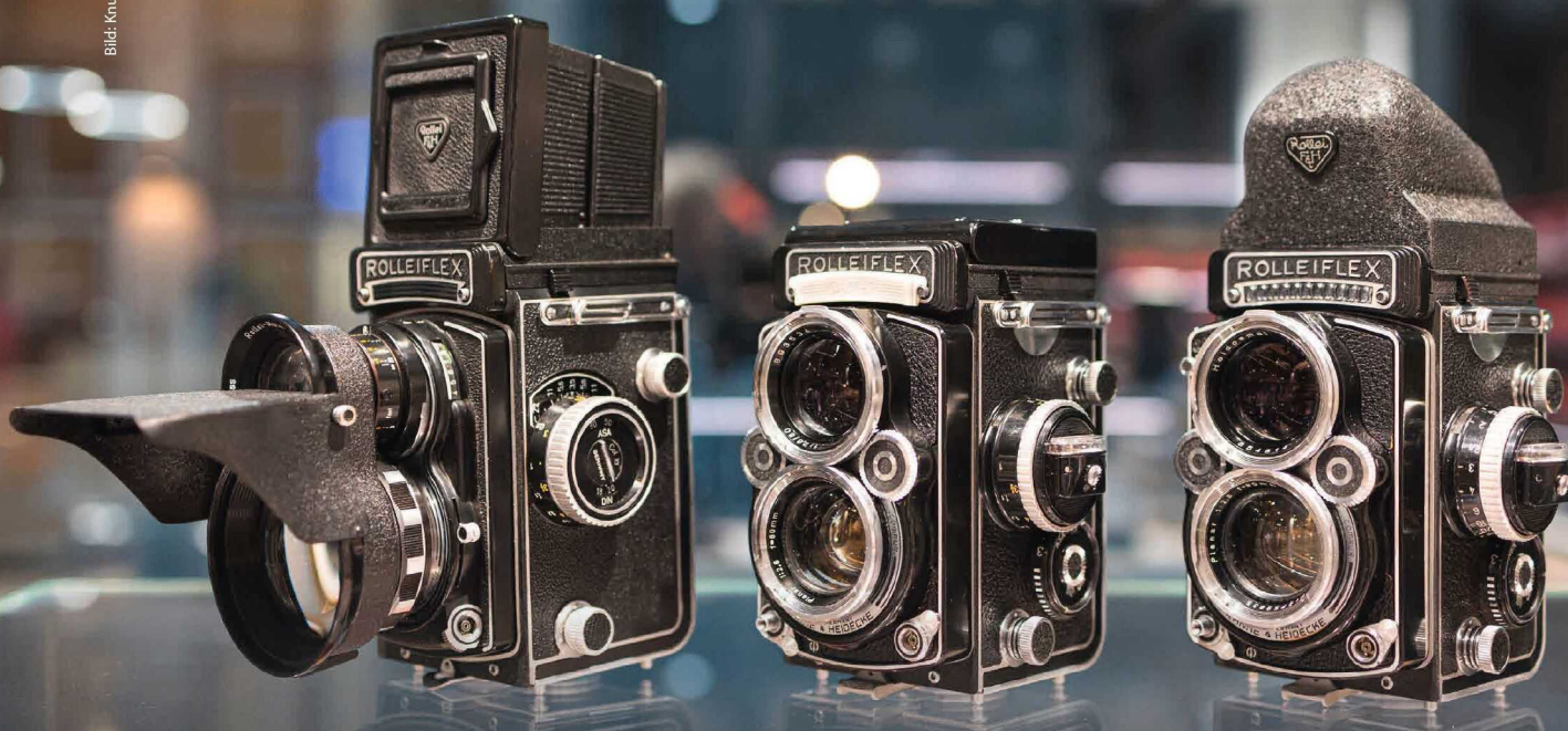
V.l.n.r.: Rolleiflex T 3,5/75mm mit Mutar 1,5 Televersatz zur Vergrößerung der Brennweite und dazu gehöriger Gegenlichtblende, Rolleiflex 2,8F mit Diffusorvorsatz zur Lichtmessung und Rolleiflex 2,8F mit aufgesetztem Prismensucher zur seitenrichtigen Darstellung des Sucherbildes.
