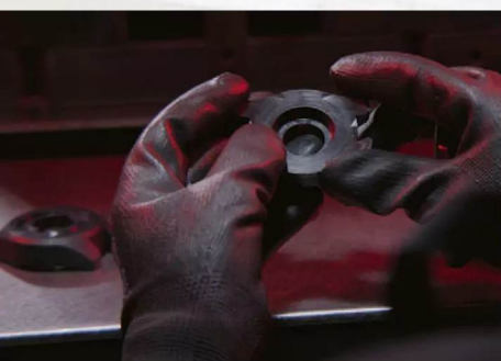
Gehäuseherstellung: Der Rohling entsteht im 3D-Druck.
