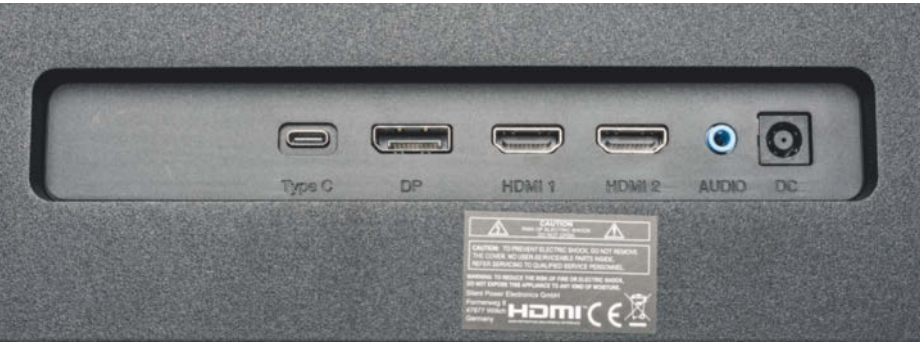
Ein Monitor mit USB-C-Eingang ist die eleganteste Docking-Lösung, aber meistens mit begrenztem Funktionsumfang. Oft sind USB-Transfers mit maximal 5 Gbit/s möglich und die Ladeleistung bleibt unter 90 Watt – oder es gibt nichts von beidem wie bei diesem billigen USB-C-Display.
