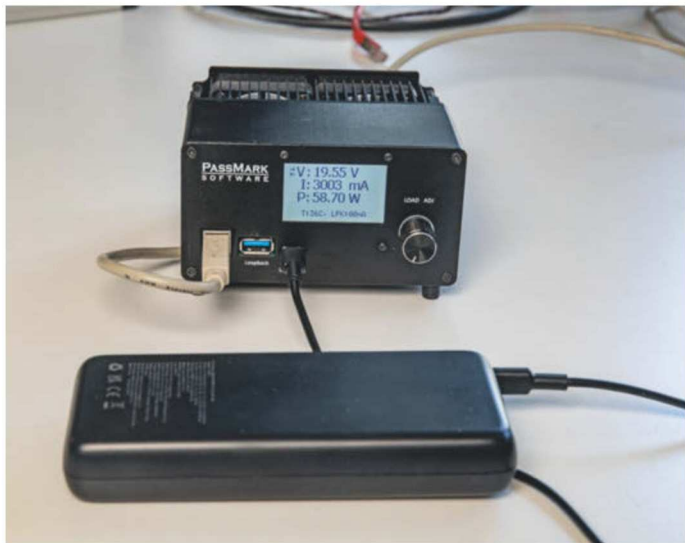
Der USB Power Delivery Tester zeigt, wie viel elektrische Leistung USB-Netzteile und -Powerbanks tatsächlich liefern. Die Abwärme des verheizten Ladestroms verteilen zwei Lüfter auf der Rückseite.
