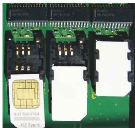
Sieh an: Die Sicherheitsmodulkarten in den KoCoBox-Konnektoren von CGM sind doch nicht mit dem Gerät „fest verbunden“.
