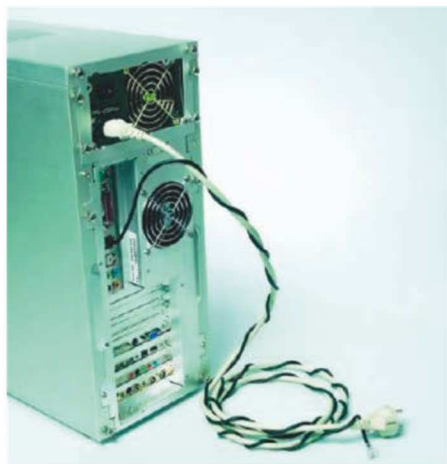
Ein locker ums Stromkabel gewickeltes Netzkabel diente 2005 als Antenne zum Empfang von DVB-P: digitalem Fernsehen per Stromanschluss.
