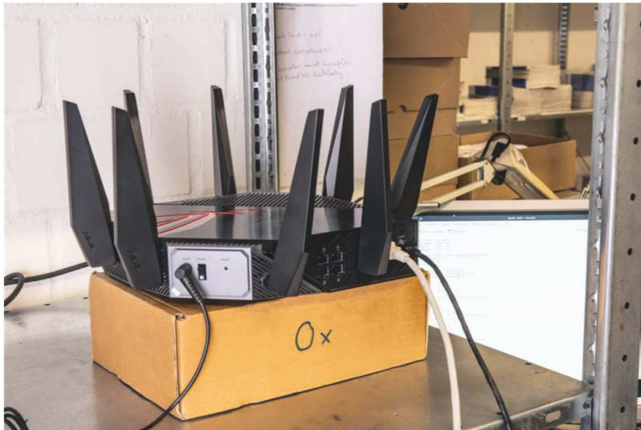
Um die WLAN-Geschwindigkeit von PCs, Notebooks oder Smartphones mit modernen Funkstandards wie Wi-Fi 6E zu ermitteln, kommt als Gegenstelle zurzeit ein Router mit acht Antennen zum Einsatz.
