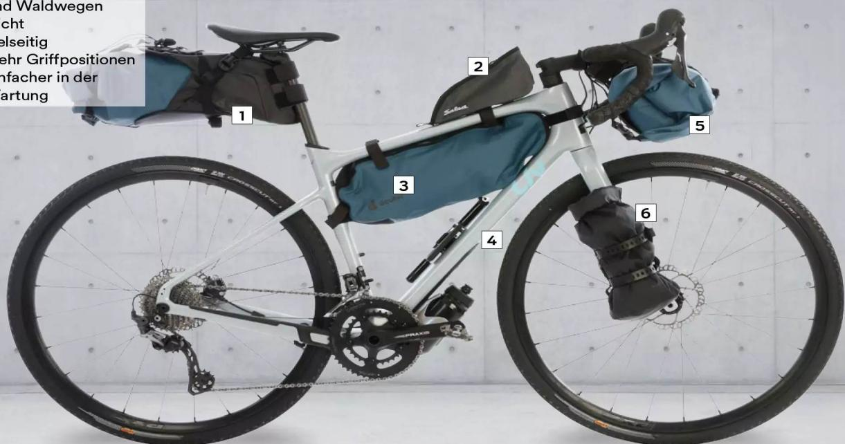
**1 Deuter Cabezon SB 16:** Der wasserdichte Packsack fasst 16 Liter. Er wird schnell und einfach in die am Heck des Bikes angebrachte Halterung gesetzt und festgezurrt.
