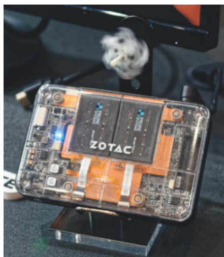
Statt Lüftern fächeln schwingende Membranen die warme Luft aus dem Mini-PC ZBox Pico PI430AJ.
