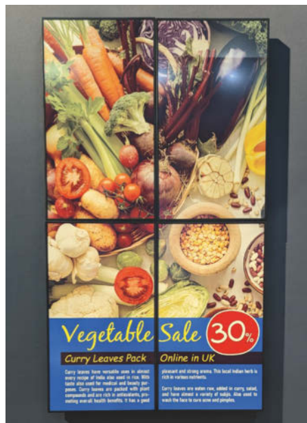
E-Paper-Displays aus E Inks Spectra-6-Serie nutzen Kügelchen in vier verschiedenen Tönen, um vollfarbige Bilder anzuzeigen.
