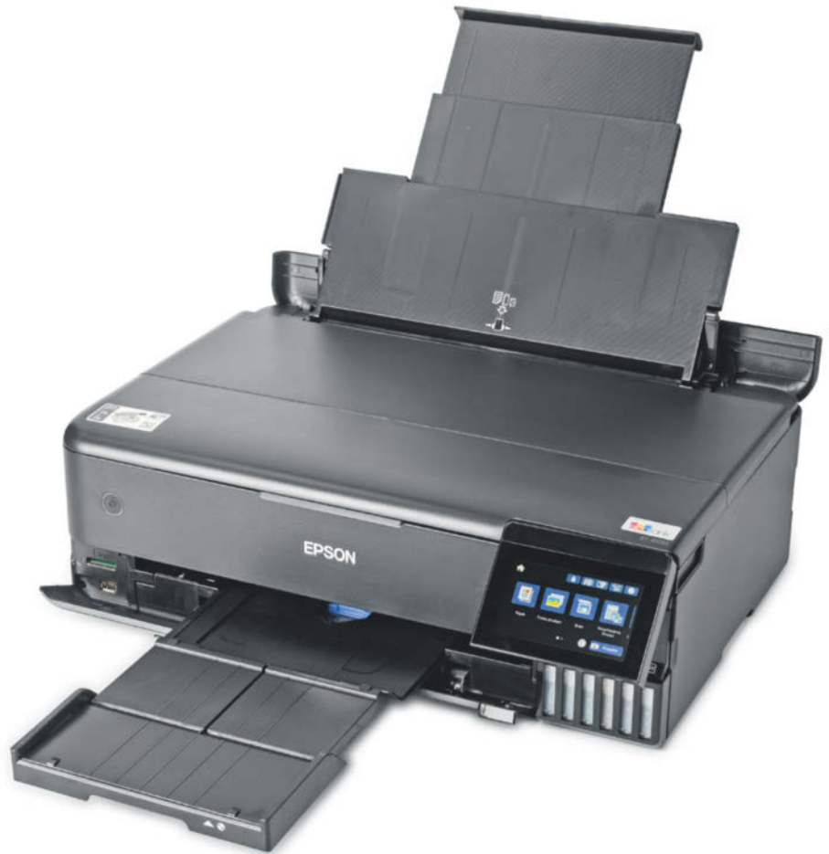
Epsons EcoTank ET-8550 druckt Fotos bis DIN A3 und entnimmt die Tinte aus sechs günstig nachfüllbaren Tanks.
