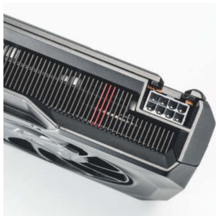
Der 8-Pol-Anschluss der Referenzkarte hat zu wenig Platz für den Einrastmechanismus einiger Netzteilstecker, AMD will an der Rückplatte nachbessern.
