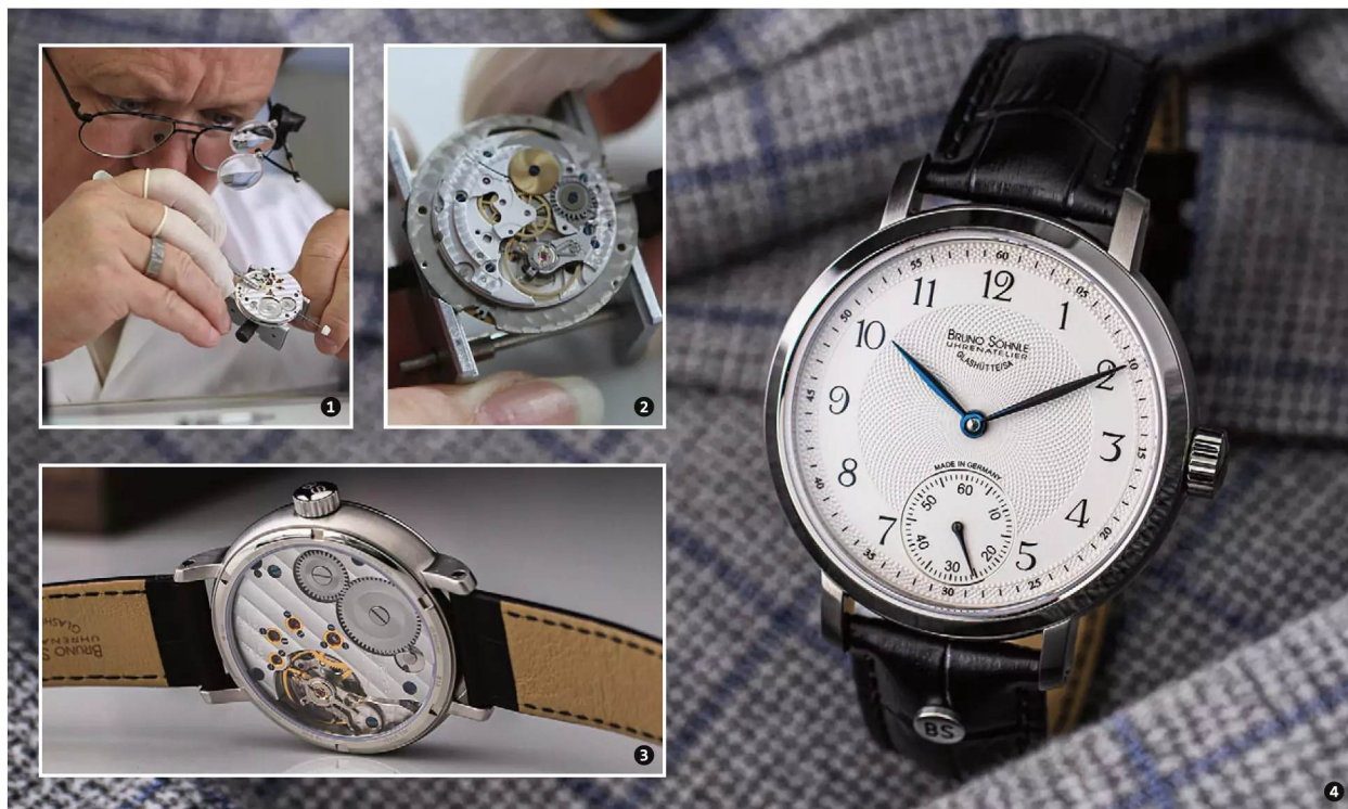
1 Uhrenatelier in Glashütte: Endmontage des Uhrwerks.
