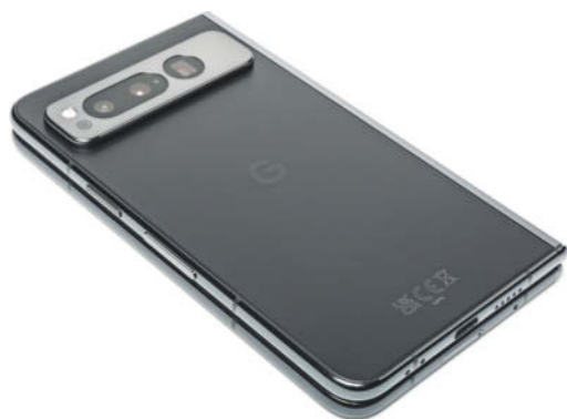
Im Steg des Pixel Fold stecken die Hauptkamera sowie ein Tele und eine Ultraweitwinkelkamera.
