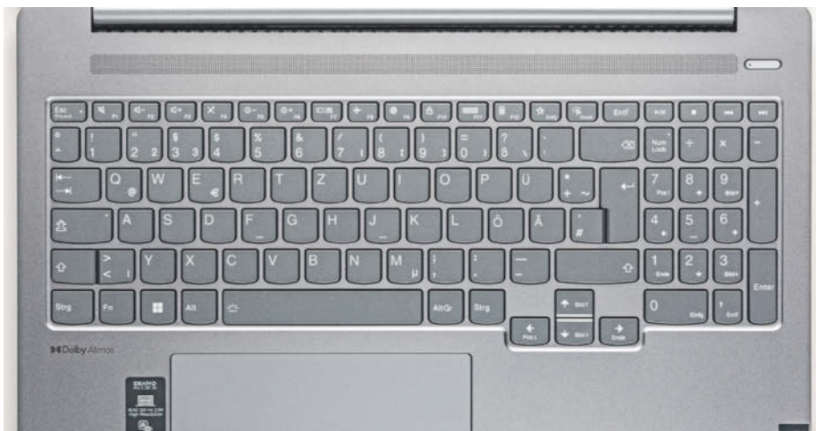
Das Tastaturlayout des Lenovo IdeaPad Pro 5 überzeugt mit zweizeiliger Enter-Taste, vierspaltigem Ziffernblock, nach vorne abgesetzten Cursor-Tasten und abseits des Tastenfelds platziertem Einschalter.
