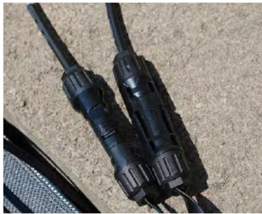
Die MC4-Stecker sind klasse und lassen sich auch ohne Werkzeug trennen.
