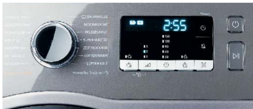
Restlaufanzeige. Einige Geräte sagen die Trockenzeit sehr ungenau voraus.
