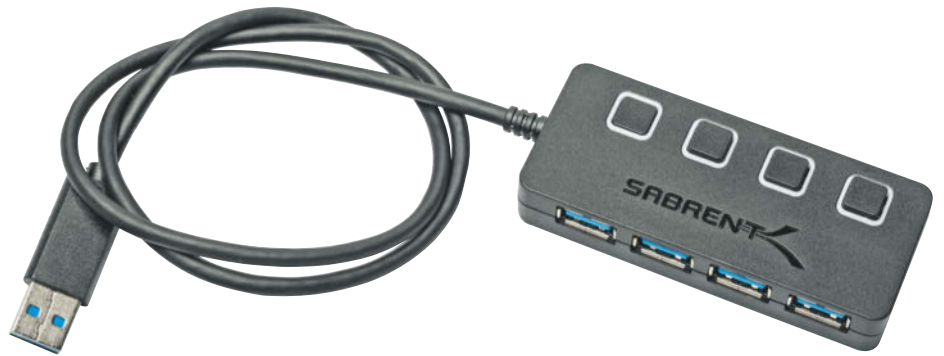
Der Vierfach-USB-Hub von Sabrent enthält ältere Technik, interessant wird er nur durch die einzeln schaltbaren Buchsen.
