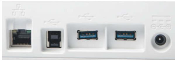
Der Avison-Scanner AN335WL hat außer Ethernet und USB-Anschluss zum PC gleich zwei USB-Host-Ports für Speichersticks und andere externe Laufwerke.
