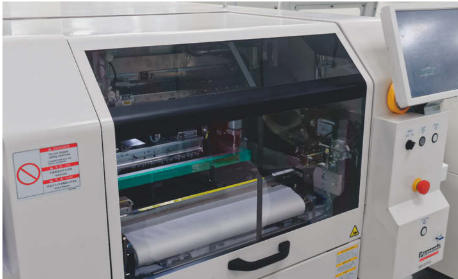
Per Schablone kommt die Lotpaste für die SMD-Bauteile an die passenden Stellen der Grafikkartenplatine. Das gelingt mit einer Genauigkeit von vier Mikrometern.
