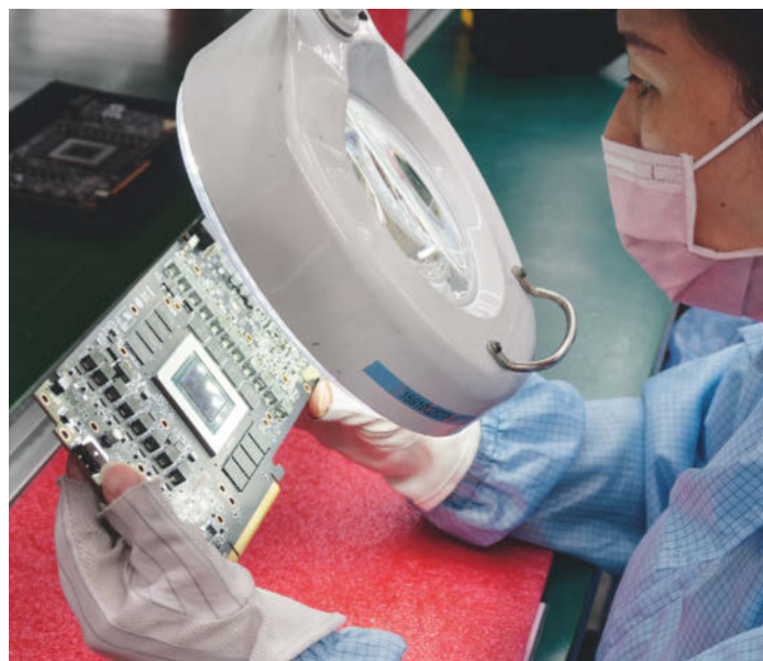
Bei dieser Radeon RX 7900 XTX fehlen noch Kühler und Blende. Die Qualitätssicherung erfolgt sowohl durch Kameras und Röntgengeräte als auch mit dem geschulten Auge.
