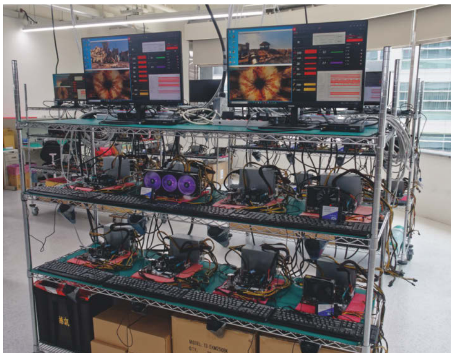
PowerColor verwendet für Langzeittests ähnliche Aufbauten, wie sie auch bei uns bei c't stehen. Hier laufen 3D-Lastprogramme wie Furmark in Dauerschleife.
