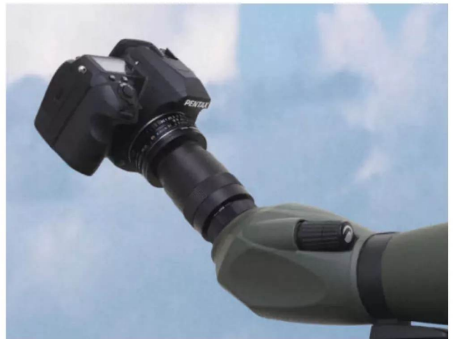
Pentax DSLR mit 40-mm-Fotoobjektiv, mit Adaptern an einen T2-Anschluss hinter das Okular des Spektivs montiert.
