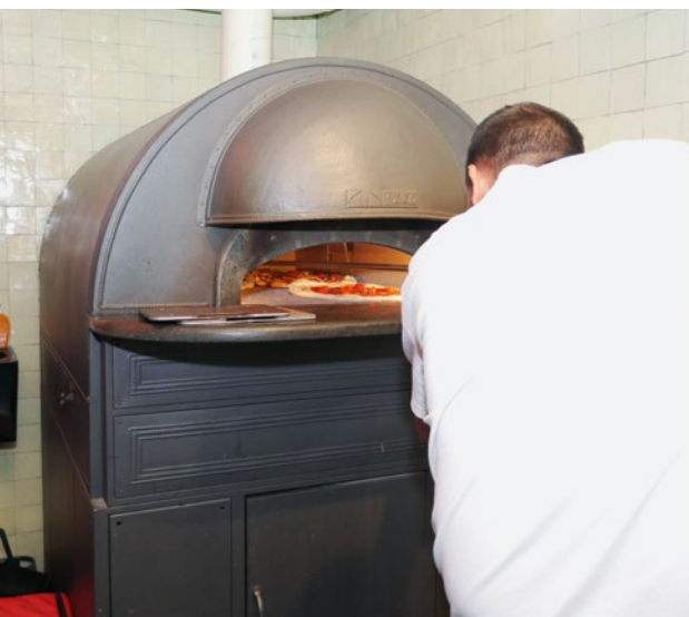
Der Ofen hält eine konstante Temperatur von 410 °C
