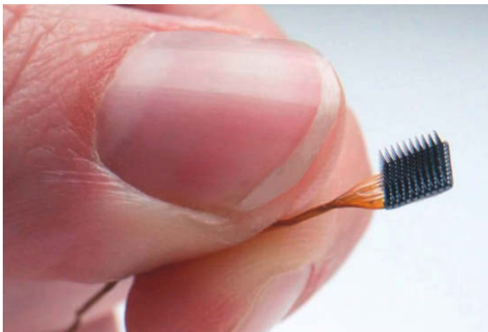
Ein Utah-Array, wie es der Patientin an der Stanford-University eingepflanzt worden ist: Über 100 Nadelelektroden dringen leicht in die Hirnrinde ein und messen dort die Hirnströme.
