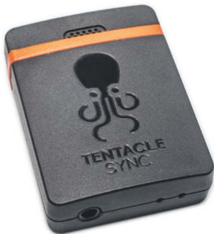
Tentacles kleine Box Sync E gibt hochpräzisen Timecode auf zwei Wegen parallel aus: über ihre Klinkenbuchse als Audiosignal und via Bluetooth-LE-Funk.
