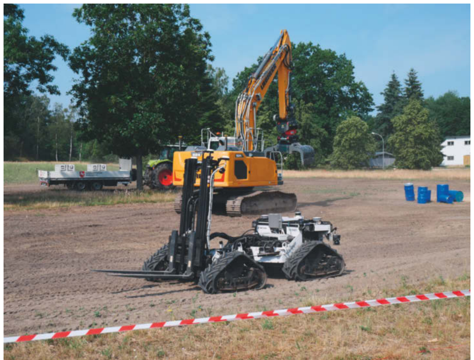
Gemeinsam rücken drei autonome Fahrzeuge an und bergen einige Fässer, selbsttätig von der Wegeplanung über die Objekterkennung bis zum Verladen auf den mitgeführten Anhänger.
