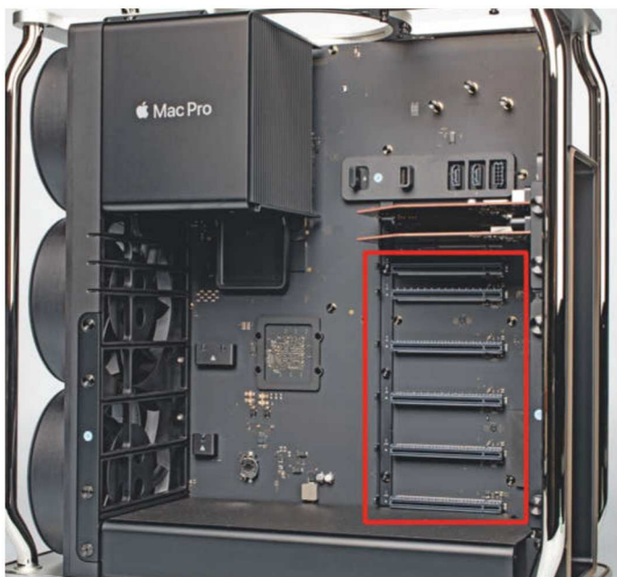
Bis zu sechs Steckkarten nimmt der Mac Pro auf. Im obersten der insgesamt sieben PCIe-Slots steckt ab Werk Apples I/O-Karte.
