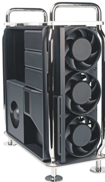
An der Front saugen drei große Lüfter stetig Luft an und pusten sie nach hinten.
