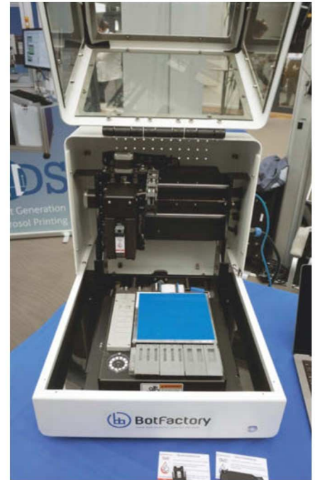
Der SV2-Drucker von BotFactory bringt leitende Tinte im thermischen Druckverfahren auf beliebige Substrate.
