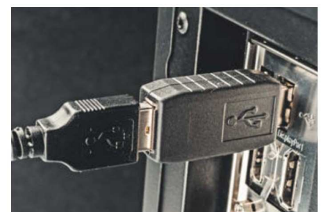
Dieser scheinbar harmlose Adapter ist ein Keylogger mit WLAN-Funktion.
